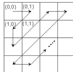
Fig.2. Zigzag Coding
