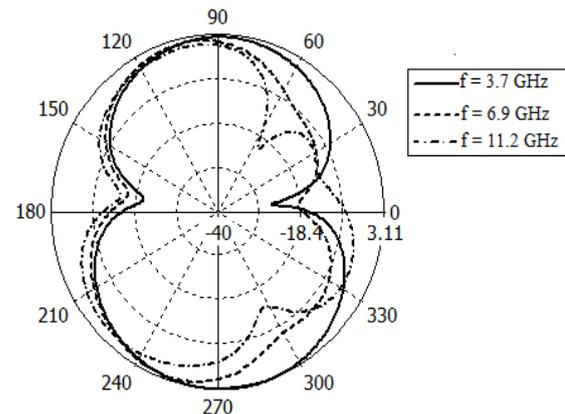
Fig. 6. E-plane radiation pattern.
