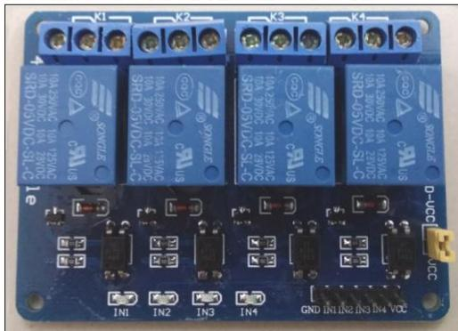
Fig. 11. Relay Module
