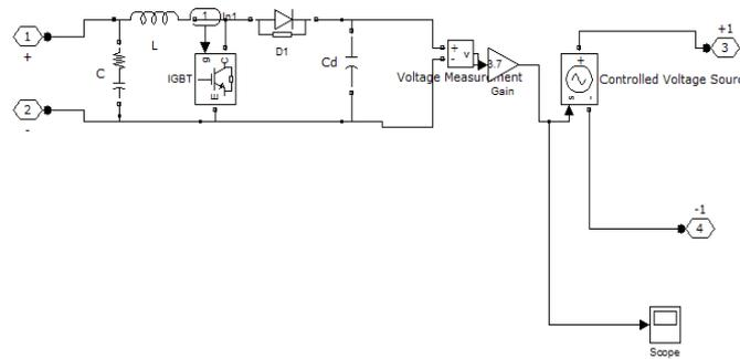
Fig. 4a) simulink model of PV array (subsystem).
