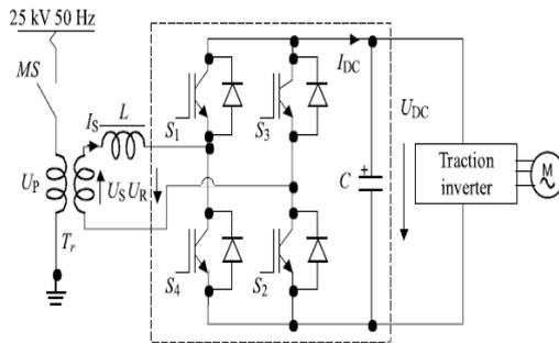
Fig. 2. Single-phase SPWM rectifier circuit
