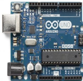
Fig. 2 Arduino Controller Atmega328P
