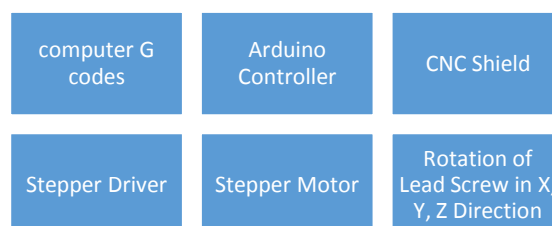
Fig. block diagram mini CNC plotter machine
