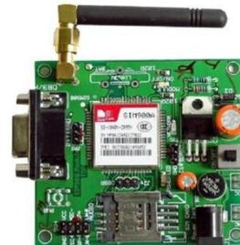
Fig; GSM module
