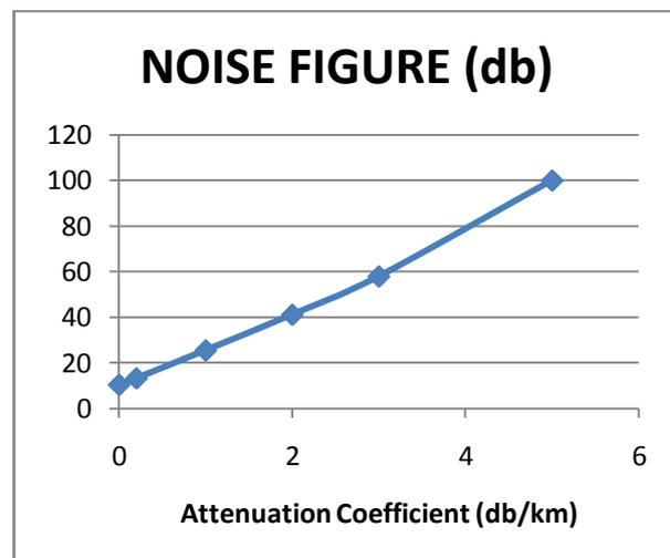
(d) Attenuation coefficient vs. Noise figure
