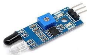
Fig. 4: IR Sensor Module
