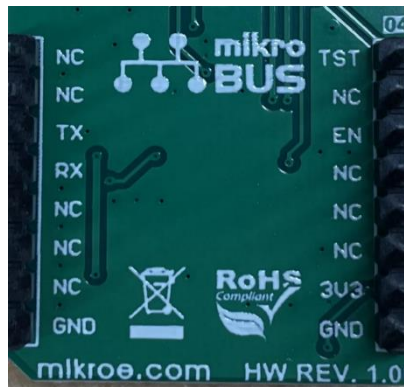
Fig. 4 Pin layout for PGA460-Q1.
