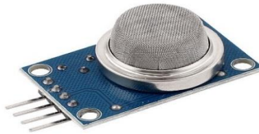
Fig 5 MQ135 Gas sensor
