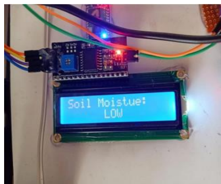
Fig.5. Moisture content display
