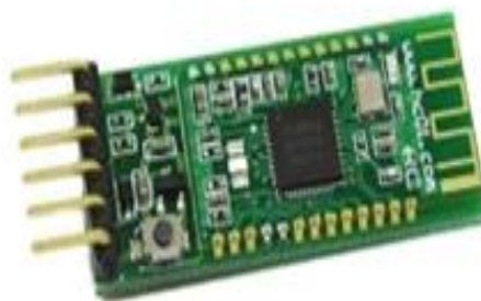
Fig. 4 HC-42 Bluetooth Module
