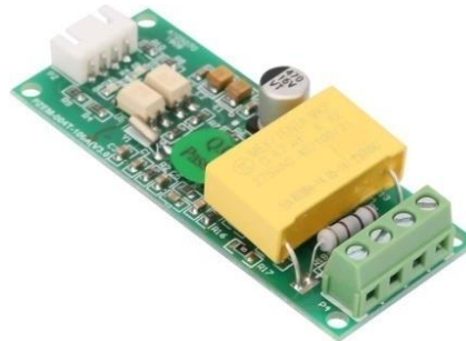
Fig. 4. ZMPT004T AC Voltage Sensor Module.
