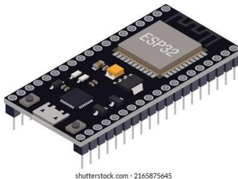
Fig. 3. ESP32 Microcontroller Module.
